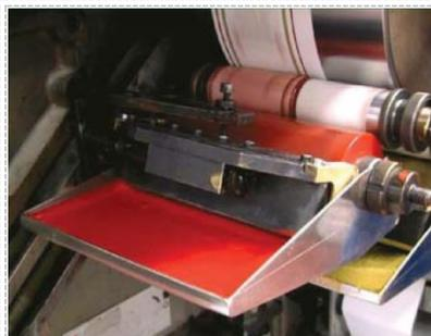
去除苯胺印刷机滚筒上的油墨
